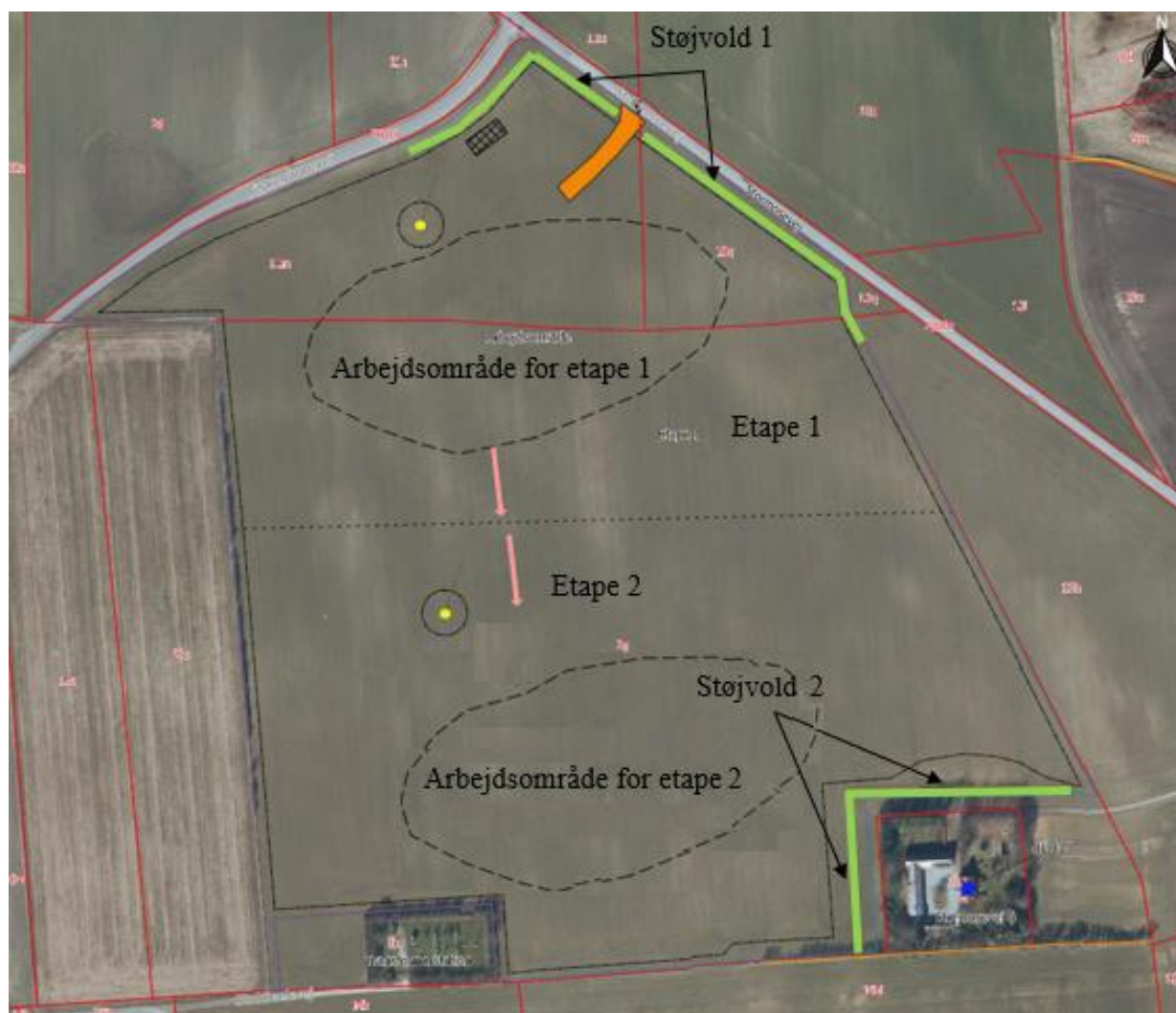
Figur 1: Udsnit af skitse af de to etaper, som rapporten omhandler. Den grønne streg illustrerer støjvolde. Blå streg illustrerer det ansøgte graveareal, sort streg illustrerer gravegrænser, stiplede sort streg illustrerer arbejdsareal og orange streg illustrerer adgangsveje.
