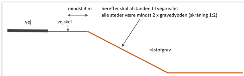
Figur 3. Principskitse for udgravning nær offentlig vej og privat fællesvej uden særskilt tilladelse fra vejmyndigheden.
