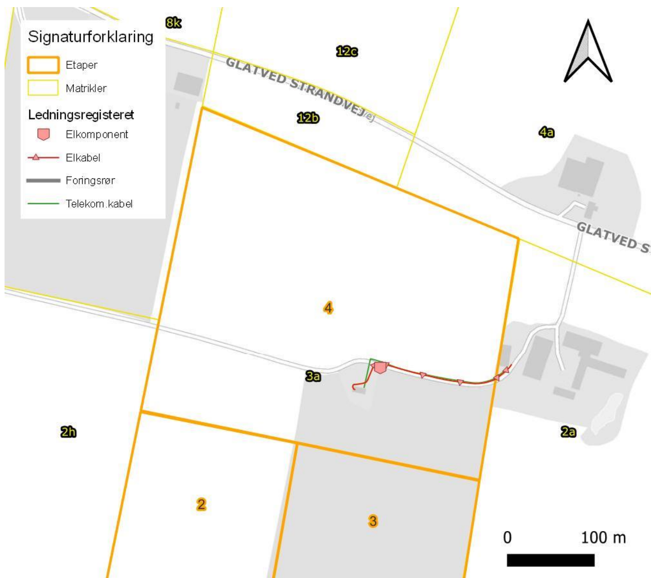
Figur 10.1 Kort med ledningsoplysninger. Elkabel er vist med rød, og telekommunikationskabler med grøn.
