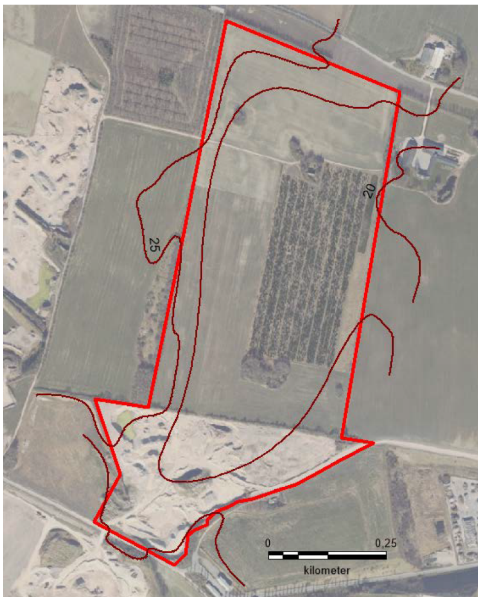
Figur 3. Vejledende koter over efterbehandlet areal. De endelige koter vil afhænge af den mængde jord, der tilføres.
