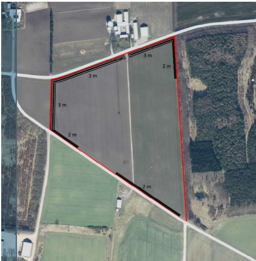
Figur 1. Etablering af nødvendige støjvolde jf. støjberegningerne vedlagt ansøgningsmaterialet i bilag B. Planlagte støjvolde er angivet med sorte streger og højden i m.
