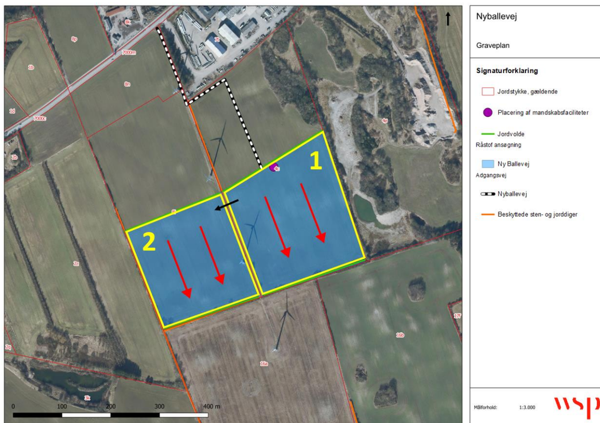
Figur 2.1. Graveplan for det ansøgte område. De gule felter viser de 2 indvindingsetaper. De røde pile angiver graveretningen, hvor det ses, at der i de to etaper vil blive gravet fra nord mod syd. Den sorte pil angiver, hvor der vil blive lavet digegennembrud.
