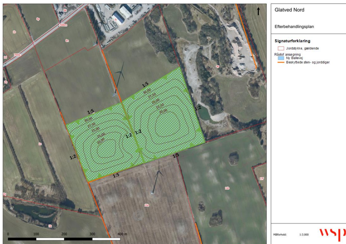
Figur 3.1. Efterbehandlingsplan for det ansøgte område. Området vil blive efterbehandlet til jordbrugsmæssigt formål, hvor terrænet for området vil skråne ind mod midten af de to matrikler.
